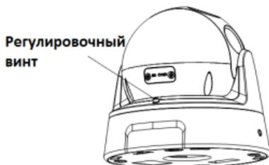
Рисунок 2-1 Ослабьте регулировочный винт
