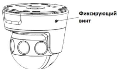
Рисунок 2-11 Отсоединение адаптерной пластины
