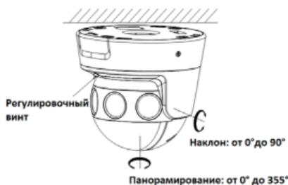
Рисунок 2-9 Регулировка угла обзора
