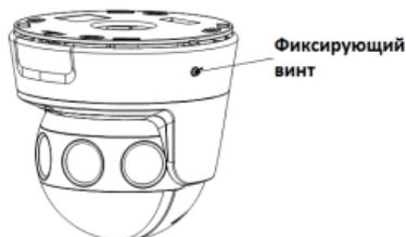
Рисунок 2-5 Отсоединение адаптерной пластины
