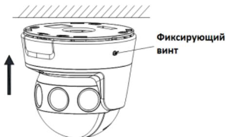
Рисунок 2-8 Закрепление камеры на адаптерной пластине
