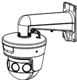
Рисунок 2-13 Установка камеры на кронштейн
