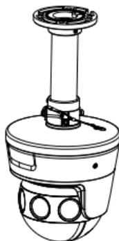
Рисунок 2-17 Установка камеры на кронштейн
